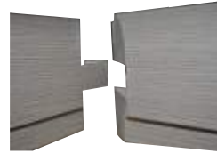
Ένωση κάσας με Φαητσογωνιά και Μόρσο
